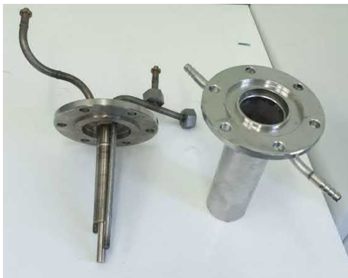
Рис. 6. Аппарат для диффузионных испытаний образца из никеля мембранным методом (фото)
