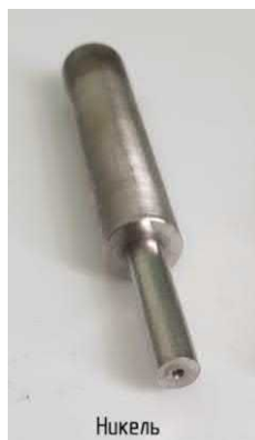
Рис. 4. Внешний вид образцов для определения диффузионных характеристик трития мембранным методом
